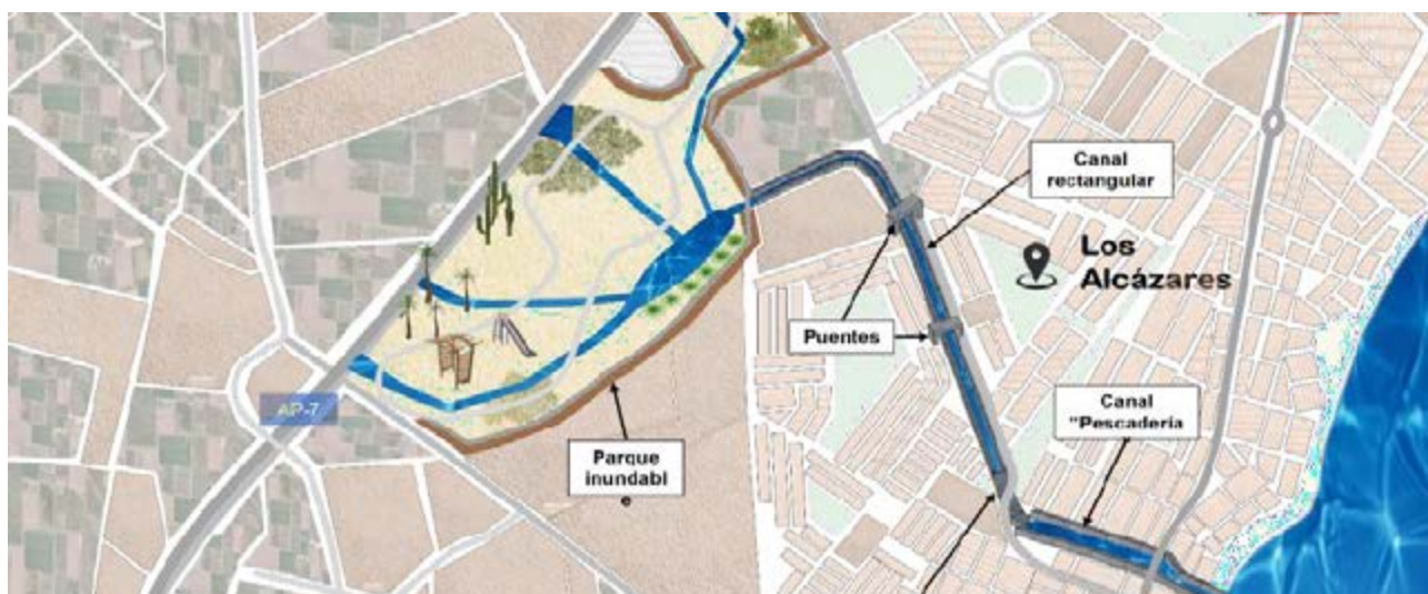
Figura. Medidas de proyección proyectadas en Los Alcázares (Murcia). Parque inundable a la salida de la A-7 que funciona como zona de almacenamiento para altos caudales.
