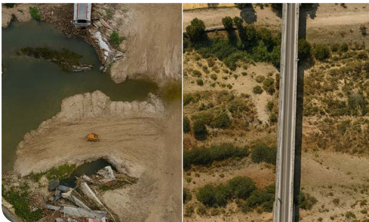
Figura. Puente de Eugenio Ribera, sobre el río Perales (Aldea del Fresno – Madrid): a) afección de la Dana del 2023; b) reconstrucción posterior a la Dana del 2023.
